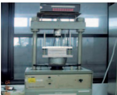
Peralatan ujian modulus daya tanah digunakan untuk menguji præ campur berteras di projek-projek kami
